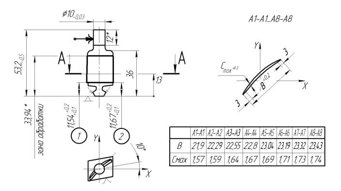
Задание 1.Выбрать способ изготовления проточной части лопатки, обеспечивающий ее изготовление за одну технологическую операцию, и исключающий доводочную обработку.
