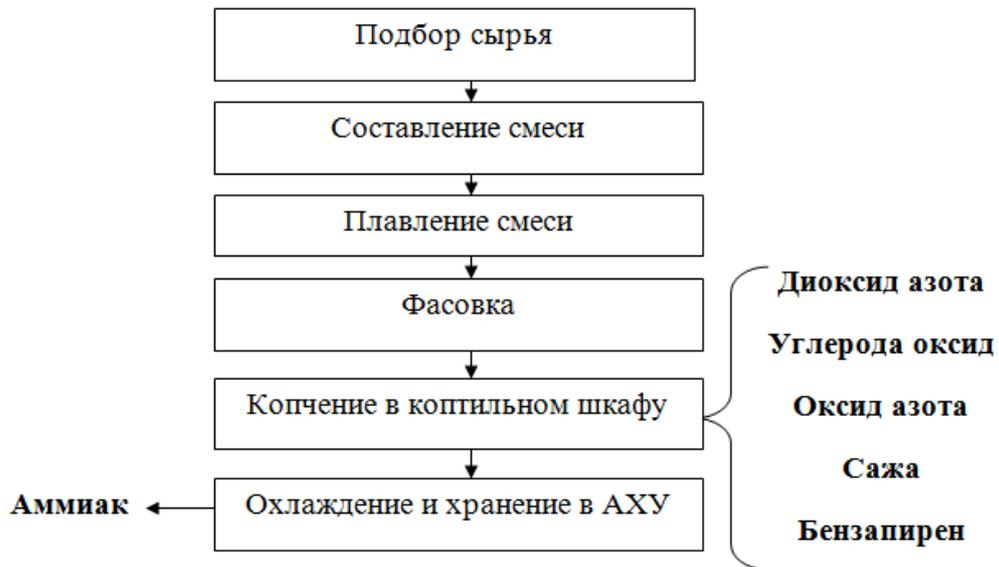
Рисунок 3 –Блок-схема технологии производства копченого сыра и образующиеся загрязняющие вещества
