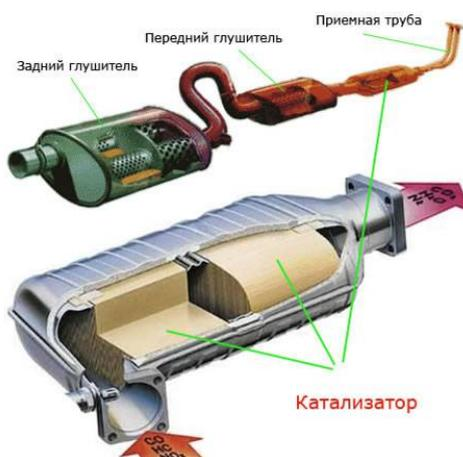
Рисунок 1 – Схема установки каталитического нейтрализатора в глушитель автомобиля
