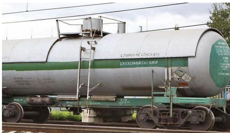
Рисунок 3 – Вагон-цистерна модели 15-1556
