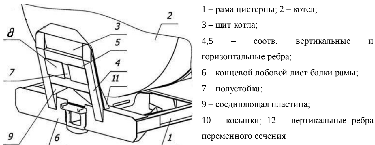
Рисунок 4 – Защитное устройство котла железнодорожной цистерны
