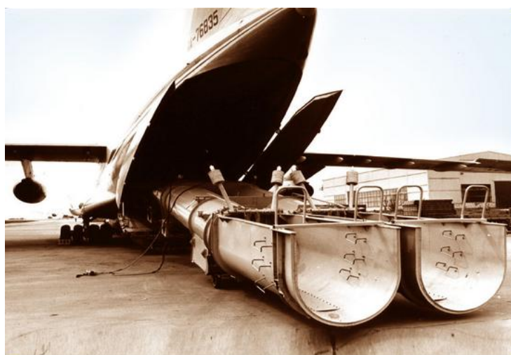
Загрузка ВАП-2 на борт. Видны выпускные лотки, рычаги управления заслонками и подкатная тележка
