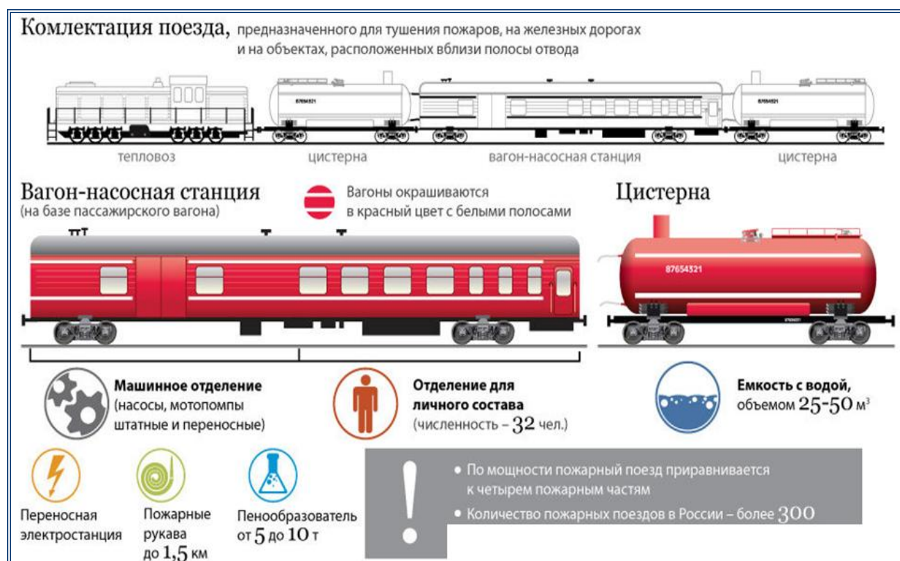
Рисунок 6 – Комплектация и основные характеристики пожарного поезда
