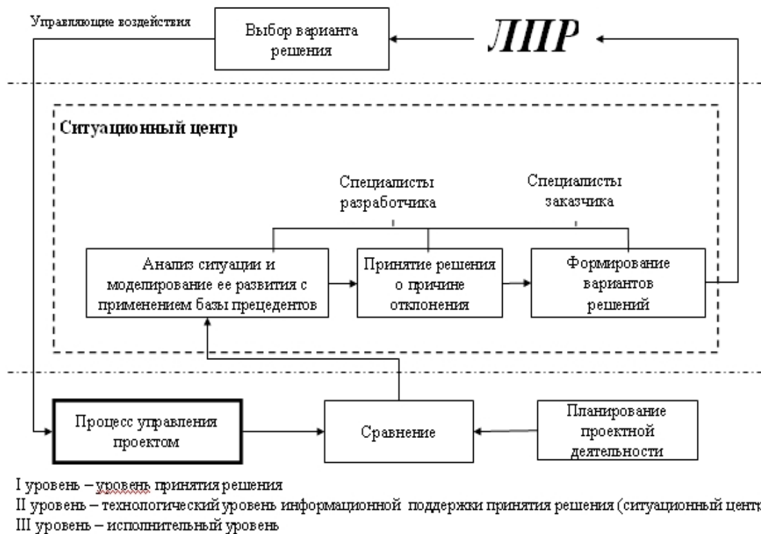
Рисунок 5 – Контур управления при информационной поддержке принятия решения при ИС
