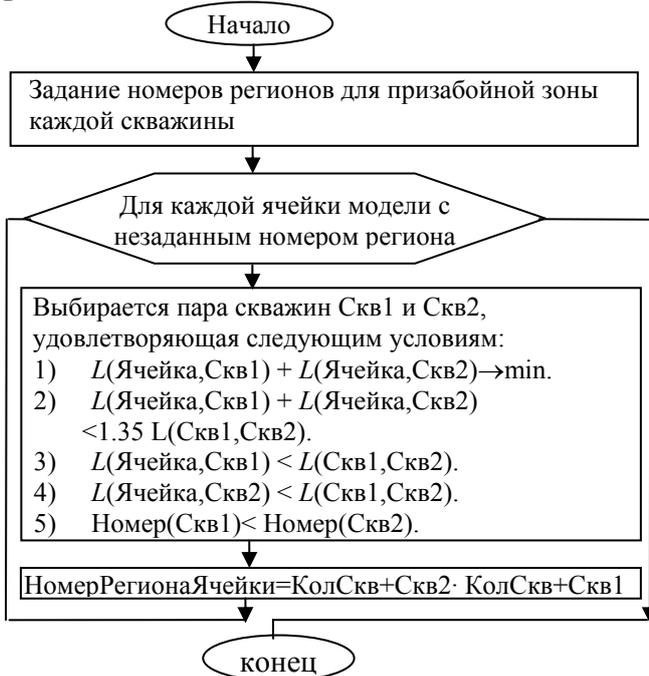
Рисунок 3 – Блок-схема алгоритма разбиения карты проницаемости на регионы:  $L$  – расстояние между ячейками
