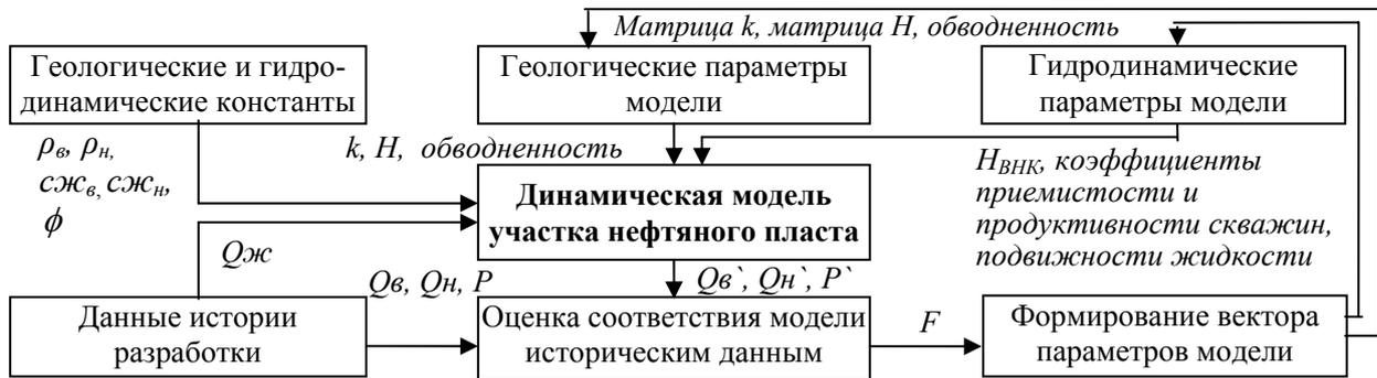
Рисунок 5 – Схема работы алгоритма идентификации параметров модели участка пласта:  $\rho_v$  – плотность воды;  $\rho_n$  – плотность нефти;  $сж_v$  – коэффициент сжимаемости воды;  $сж_n$  – коэффициент сжимаемости нефти;  $Qж$  – дебит жидкости;  $\phi$  – пористость;  $k$  – проницаемость;  $H$  – толщина пласта;  $H_{ВНК}$  – толщина водонефтяного контакта
