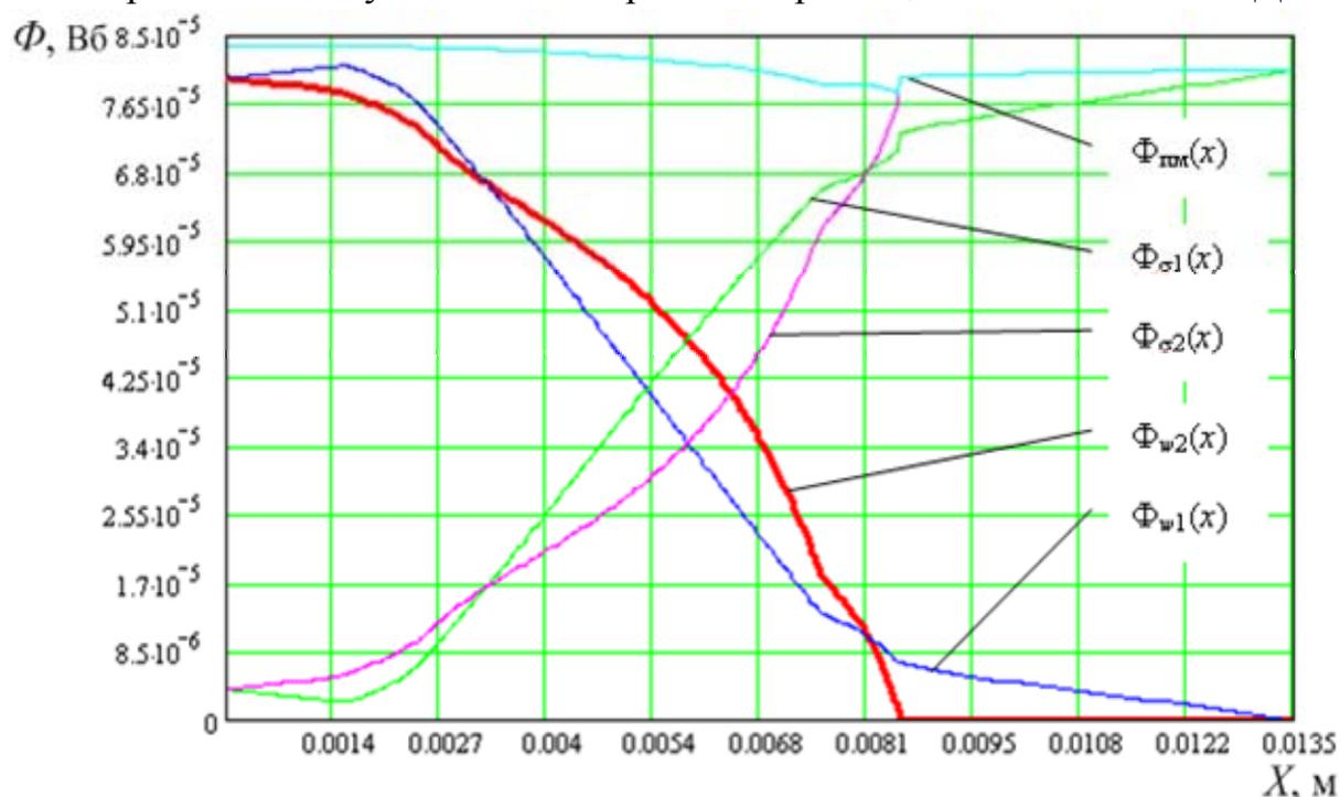
Рисунок 4 – Распределение магнитных потоков в СМЭГ ВПД на различных интервалах перемещения ПЭ
