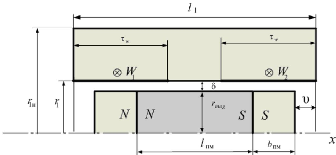
Рисунок 2 – Магнитная система СМЭГ ВПД
