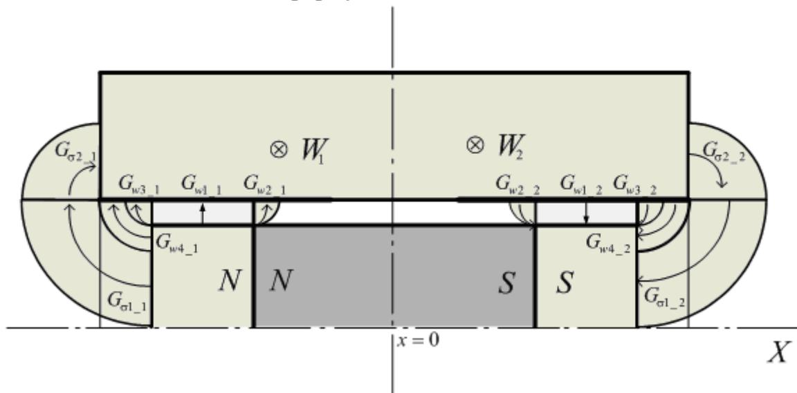
Рисунок 3 – К определению магнитных проводимостей СМЭГ ВПД
