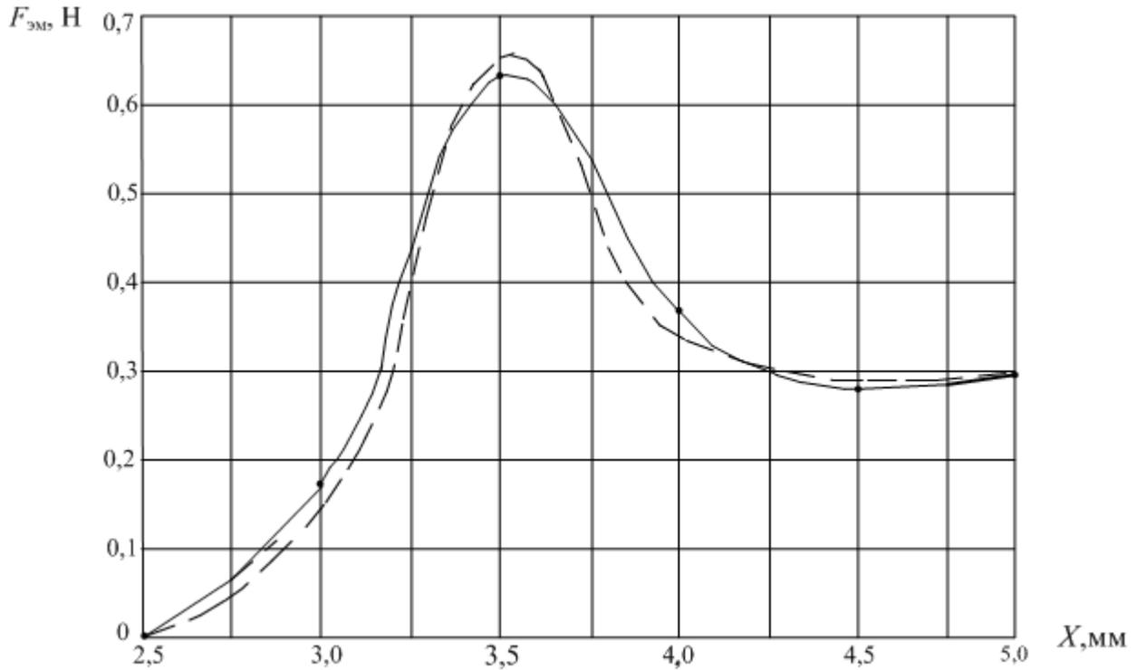
Рисунок 6 – Зависимость электромагнитной силы «магнитной пружины» от перемещения ПЭ  $F_{эм} = f(x)$ :
