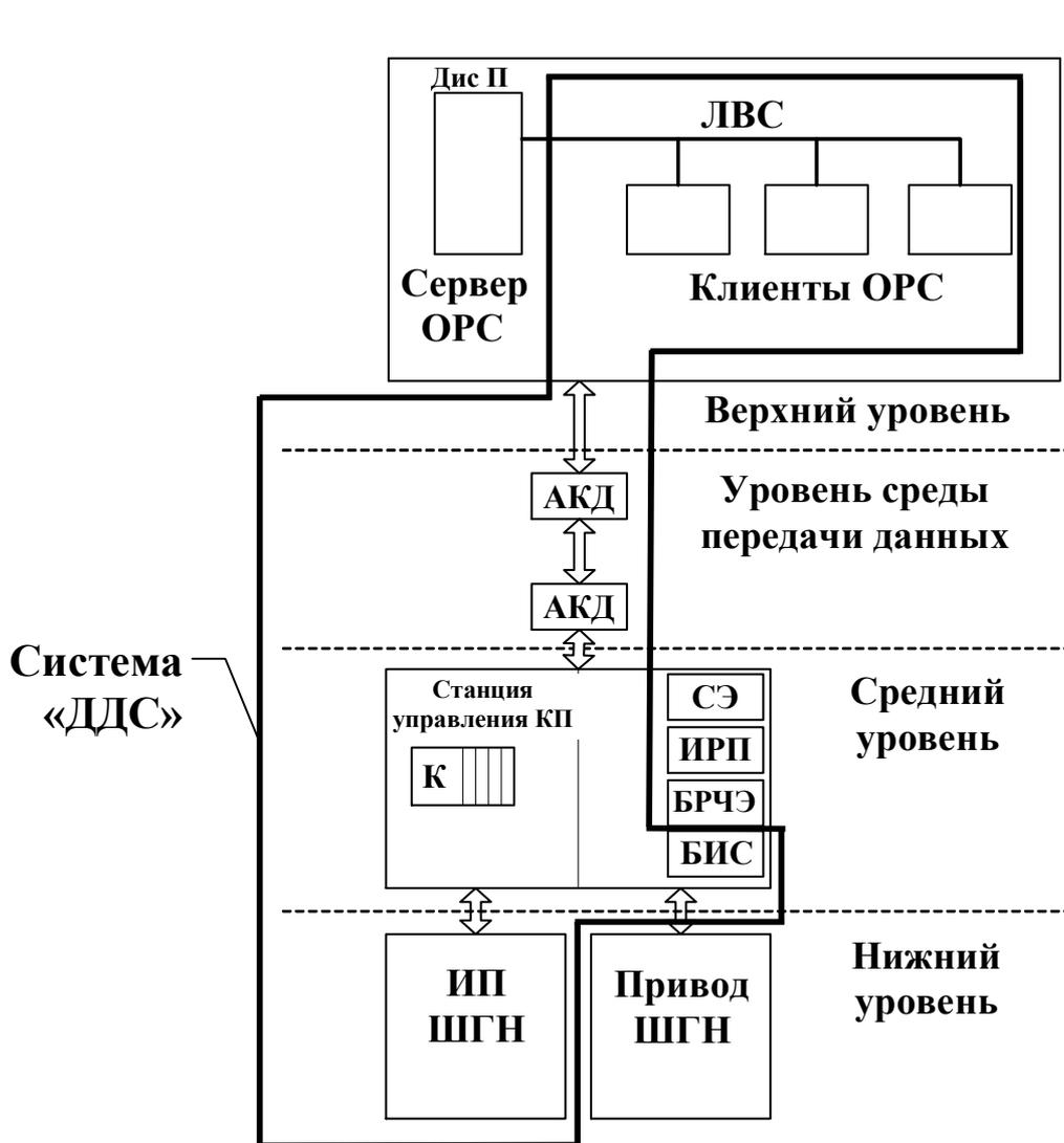
АКД – аппаратура канала данных; К – контроллер станции управления; СЭ – силовые элементы; БРЧЭ – блок регулировки частоты вращения электропривода ШГН; БИС – барьеры искрозащиты; ИРП – источник резервного питания, Дис П – диспетчерский пункт; КП – контролируемый пункт; ЛВС – локальная вычислительная сеть; OPC (Object Linking and Embedding (OLE) for Process Control) – программные технологии
