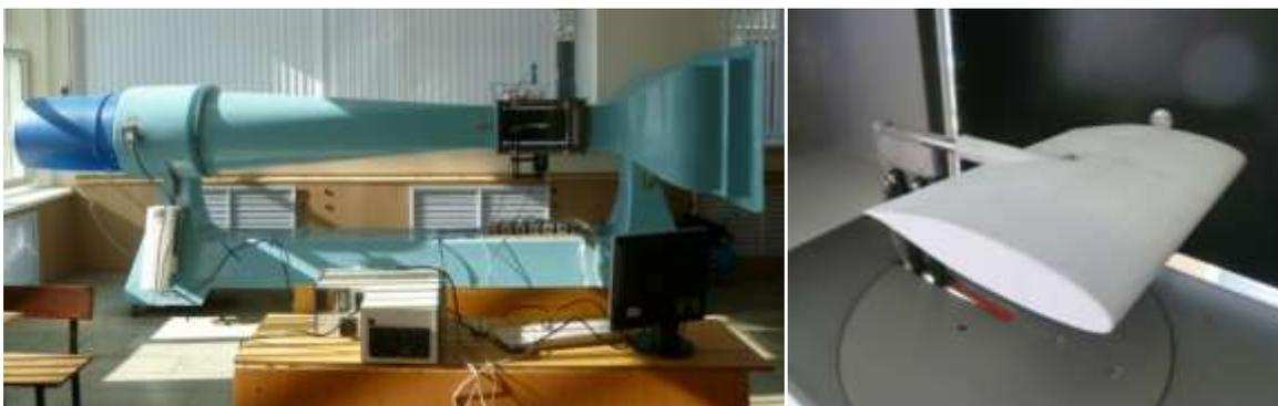
Рисунок 8 – Внешний вид аэродинамической трубы AEROLAB EWT
