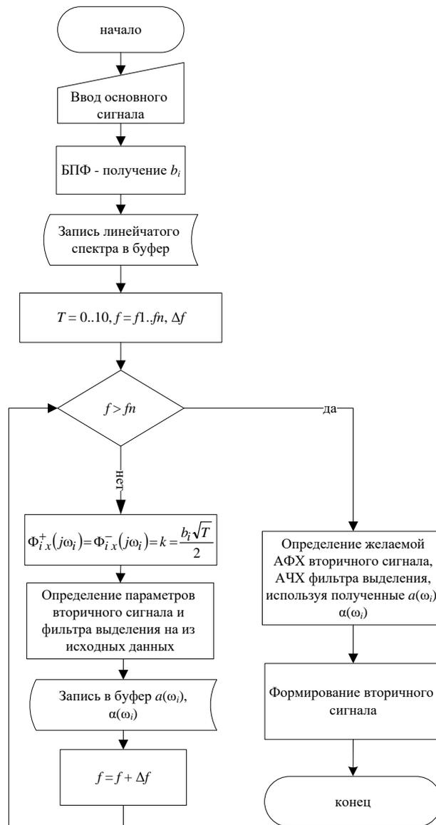
Рисунок 3.5 – Алгоритм синтеза параметров вторичного канала
