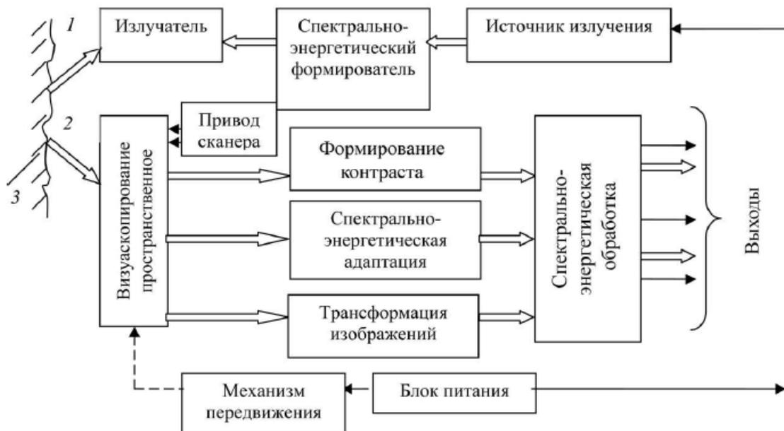
Рисунок 2.1 – Структурная схема пространственно-временного сканирования поверхностей конструктивных материалов: 1 – прямая связь, 2 – обратная связь, 3 – поверхность геометрического тела с локальными связями
