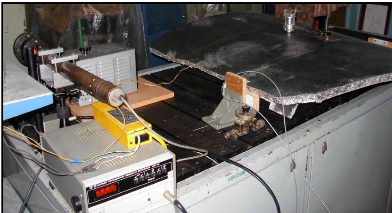
Рисунок 6.11 – Общий вид испытательного стенда для выявления дефектов многослойных клееных конструкций
