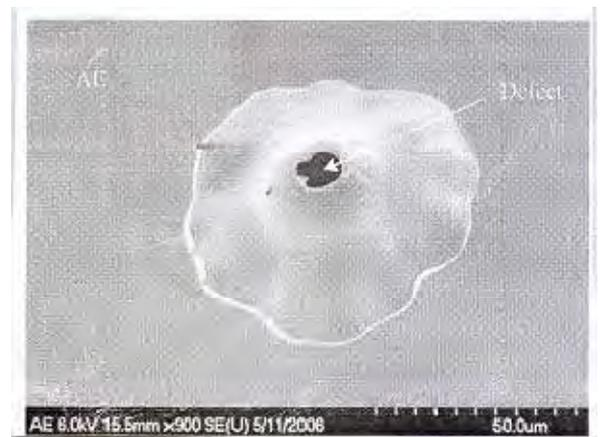
технологические дефекты (отверстия) размером 1-5μм с концентрацией ( $\sim 10^3$  отв/см<sup>2</sup>) в защитном покрытии SiO<sub>2</sub> после нанесения
