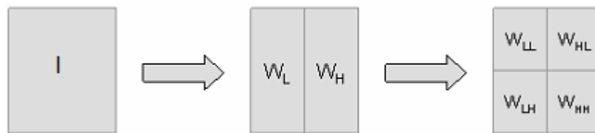
Рисунок 2.6 – Общая схема двумерного вейвлет-преобразования
