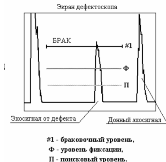
Рисунок 1.12 – Работа системы обнаружения для эхометода
