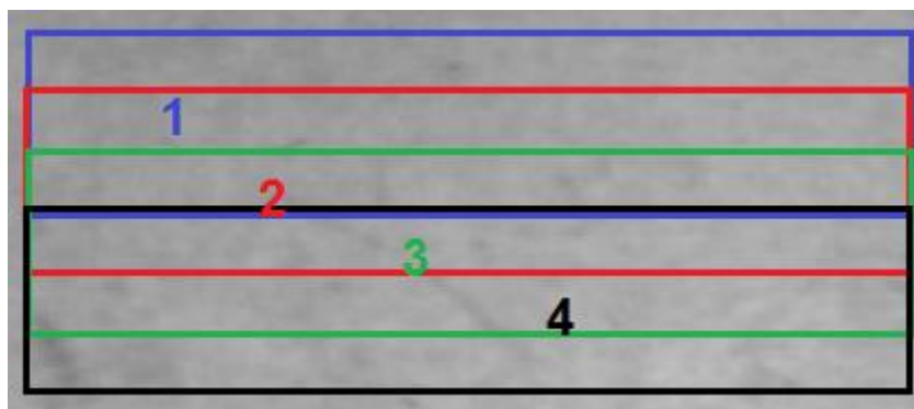
Рисунок 3.4 – Области прокатного листа, попадающие в 4 последовательных кадра
