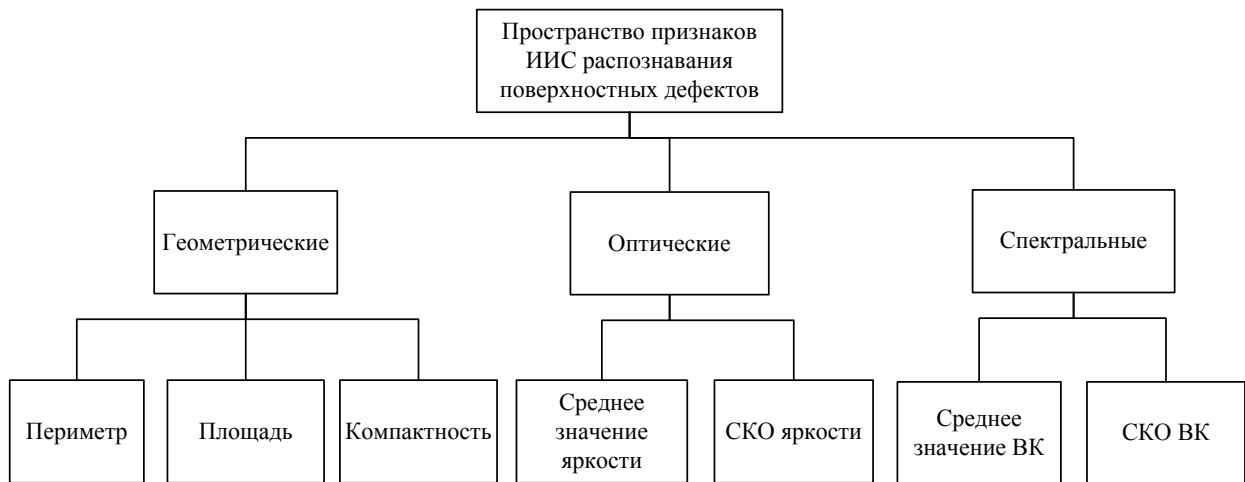
Рисунок 1.11 – Пространство признаков поверхностных дефектов
