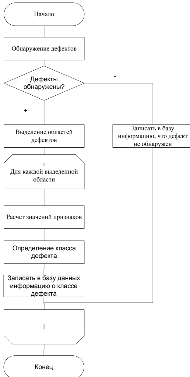
Рисунок 4.8 – Алгоритм обработки сформированного изображения
