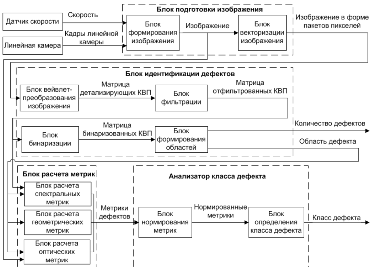
Рисунок 3.1 – реализация концепции ОЭИС распознавания поверхностных дефектов на основе модернизированной модели изображения
