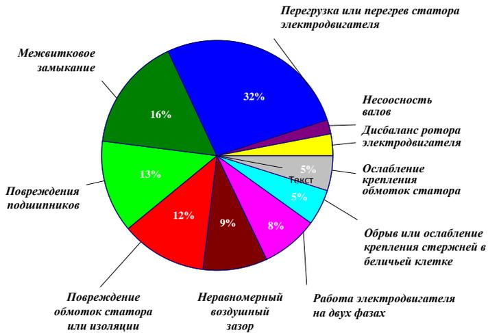
Рисунок 1 – Распределение неисправностей АД
